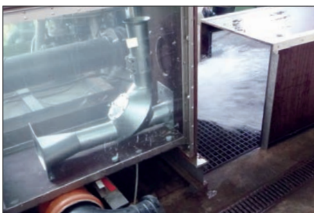
Modellversuch Maßstab 1:6 im hydraulischen Labor im Jahr 2017
