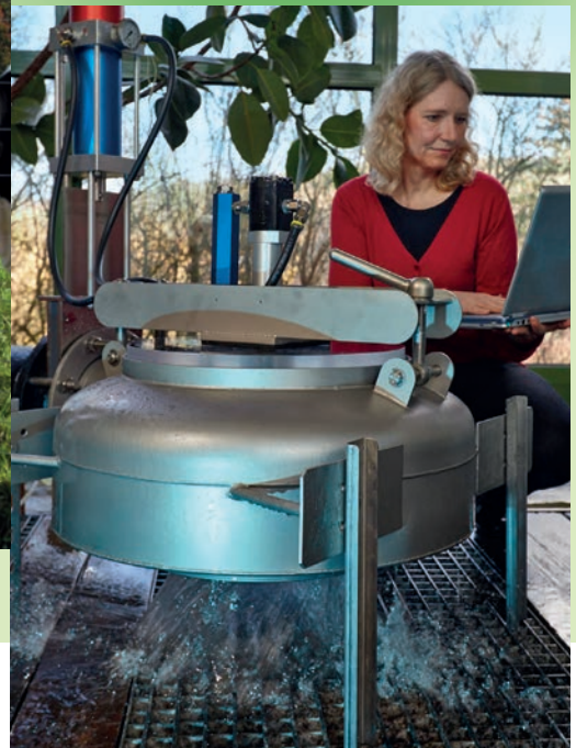
Doris Steinriede kalibriert im hydraulischen Labor eine Turbo-Wirbeldrossel
