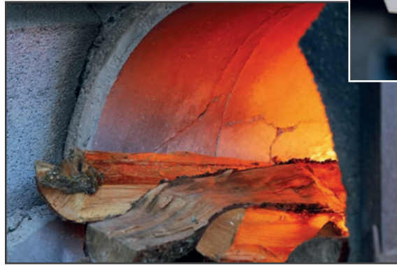
Die Luft im Gebläse wird mit Gas und Holz auf die nötige Temperatur gebracht
