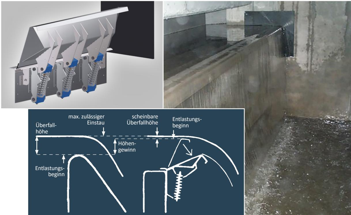
Bei der Federstauklappe (rechts) beginnt die Entlastung bei einem wesentlich höheren Wasserstand als bei einem festen Wehr (links)
