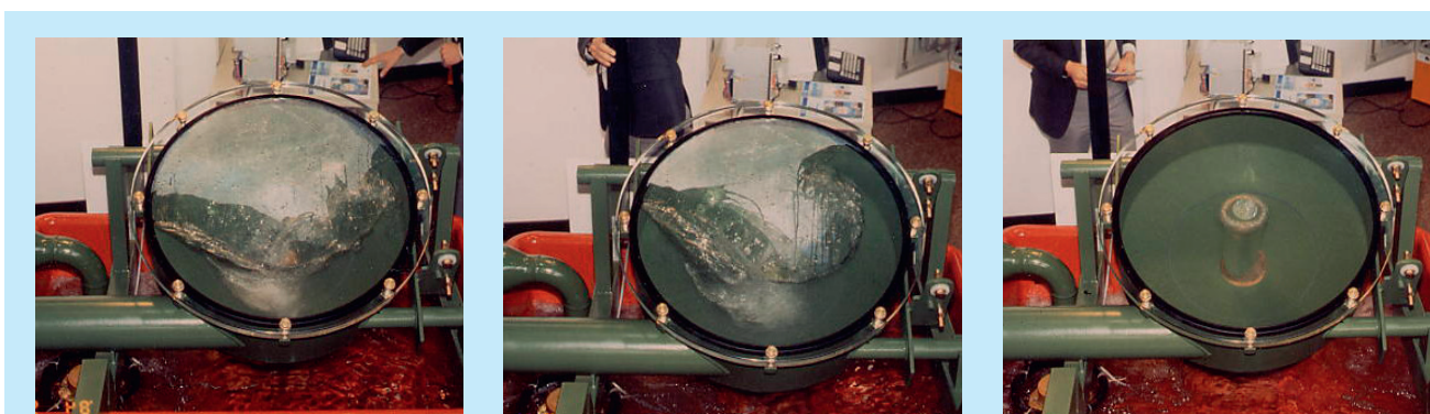
Bild 5: Anspringen der Wirbelströmung bei steigendem Vordruck
