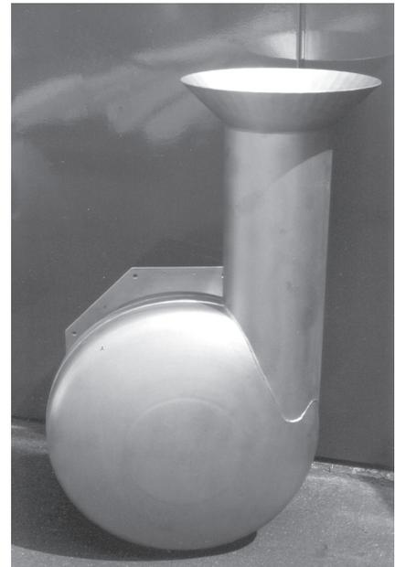
**Bild 4:** Einbaufertiges Dauerstauventil Typ 3, DN 250, ohne Ablassdeckel. Für den Grundablass ist in diesem Fall ein separater Absperrschieber vorgesehen.
