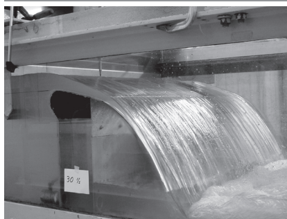
Bild 5b: Abfluss bei einer spezifischen Schwellenbelastung von 30 l/(s·m). Links im Bild die Tauchwand.
