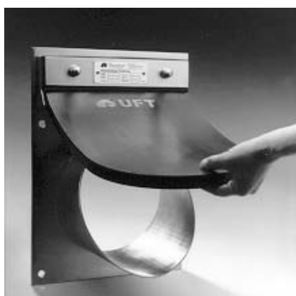
Bild 2: Die weiche Gummilasche lässt sich leicht vom Rohrstutzen abheben und dichtet bei Gegendruck auf dem schmalen Edelstahlrand der Rohrellipse zuverlässig ab
