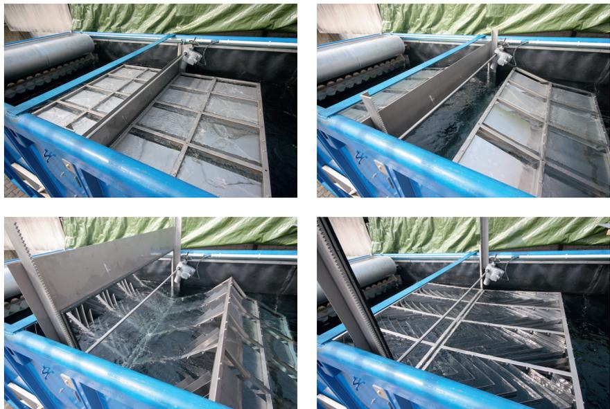
**Bild 5:** Schwenken der Kreuzstromklärerpakete, hier mit elektrischem, ex-geschütztem Antrieb in einem Testcontainer.
