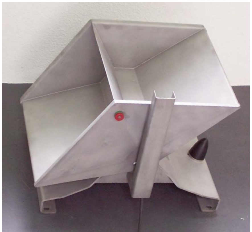
Bild 2: Kippzähler mit Magnetschalter. Die Impulse des Magnetschalters werden über das Kabel zum Datenlogger weitergeleitet und dort registriert.
