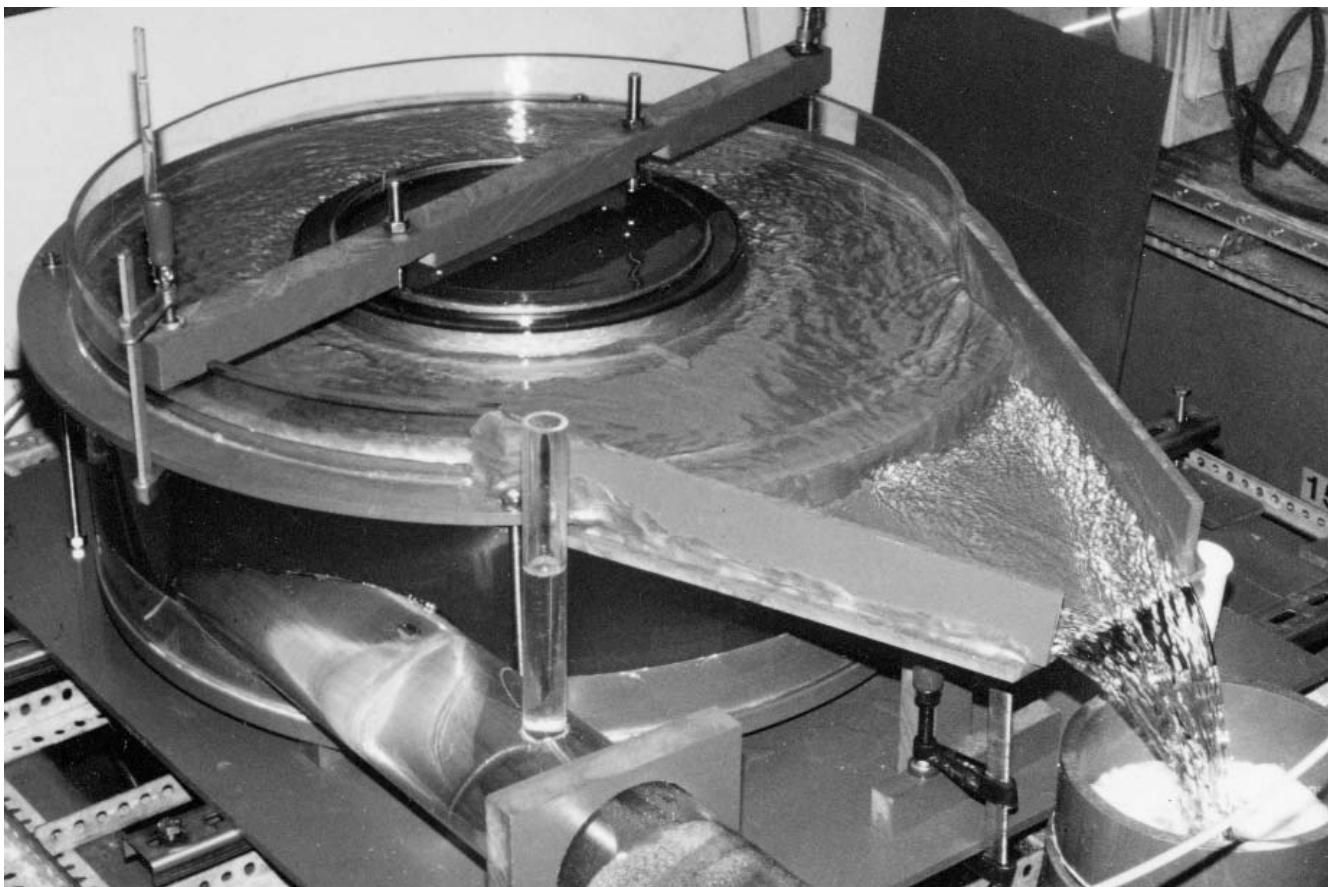
Bild 5: Modell des Wirbelabscheiders von Bild 4. In dem Sieb werden die Tracer aufgefangen, die die absetzbaren Stoffe simulieren. Modellmaßstab 1:15, maximaler Durchsatz 3,25 l/s.
